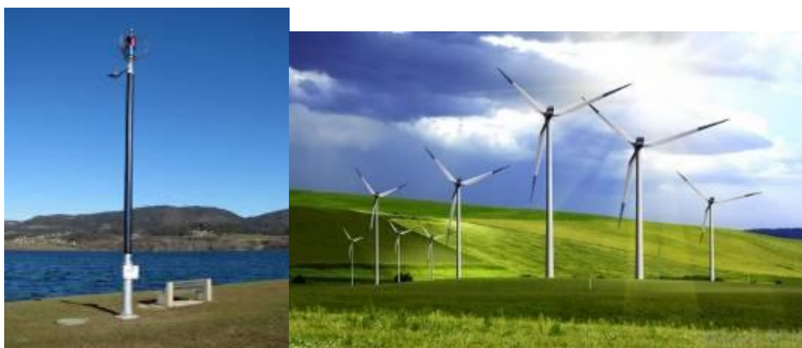
Slika 7.14.: Vanjska svjetiljka s vjetroturbinom i fotonaponskim ćelijama te vjetroelektrana
