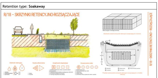
Figure: 38. Soakaway (source: Lejcuś K. at all "Katalog dobrych praktyk zasady zrównoważonego gospodarowania wodami opadowymi pochodzącymi z nawierzchni pasów drogowych. Wrocław 2017")
