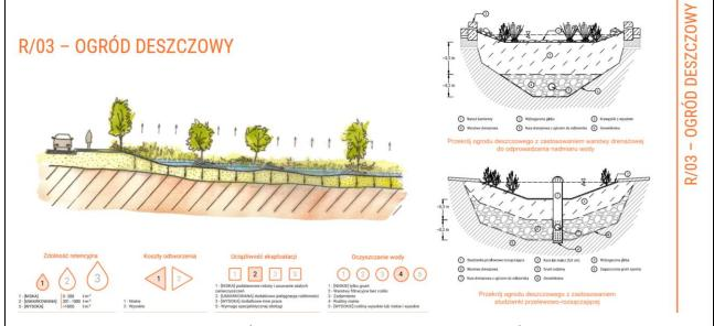
Figure: 26. Rain gardens (source: Lejcuś K. at all "Katalog dobrych praktyk zasady zrównoważonego gospodarowania wodami opadowymi pochodzącymi z nawierzchni pasów drogowych. Wrocław 2017")
