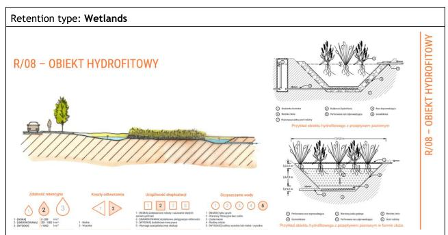
Figure: 33. Wetlands (source: Lejcuś K. at all "Katalog dobrych praktyk zasady zrównoważonego gospodarowania wodami opadowymi pochodzącymi z nawierzchni pasów drogowych. Wrocław 2017")
