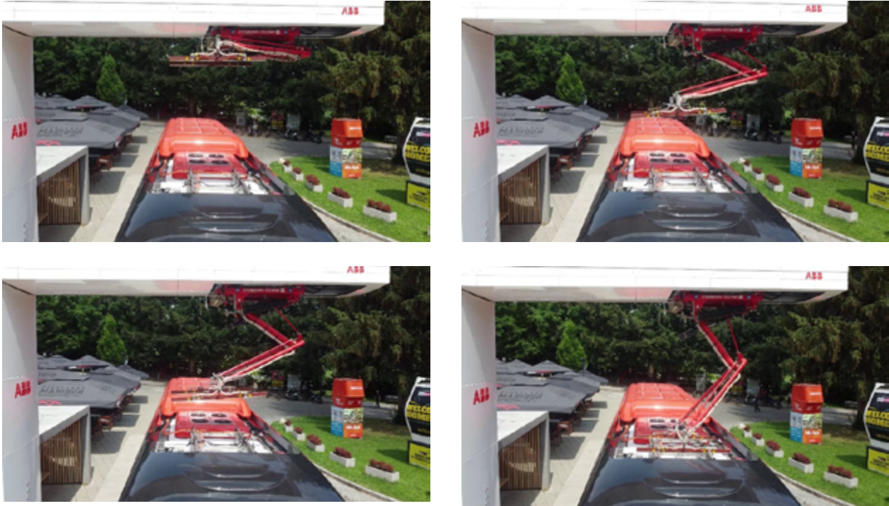
Abbildung 10: Demonstration der Funktionsweise des Stromabnehmers (Quelle: Stadt Maribor)
