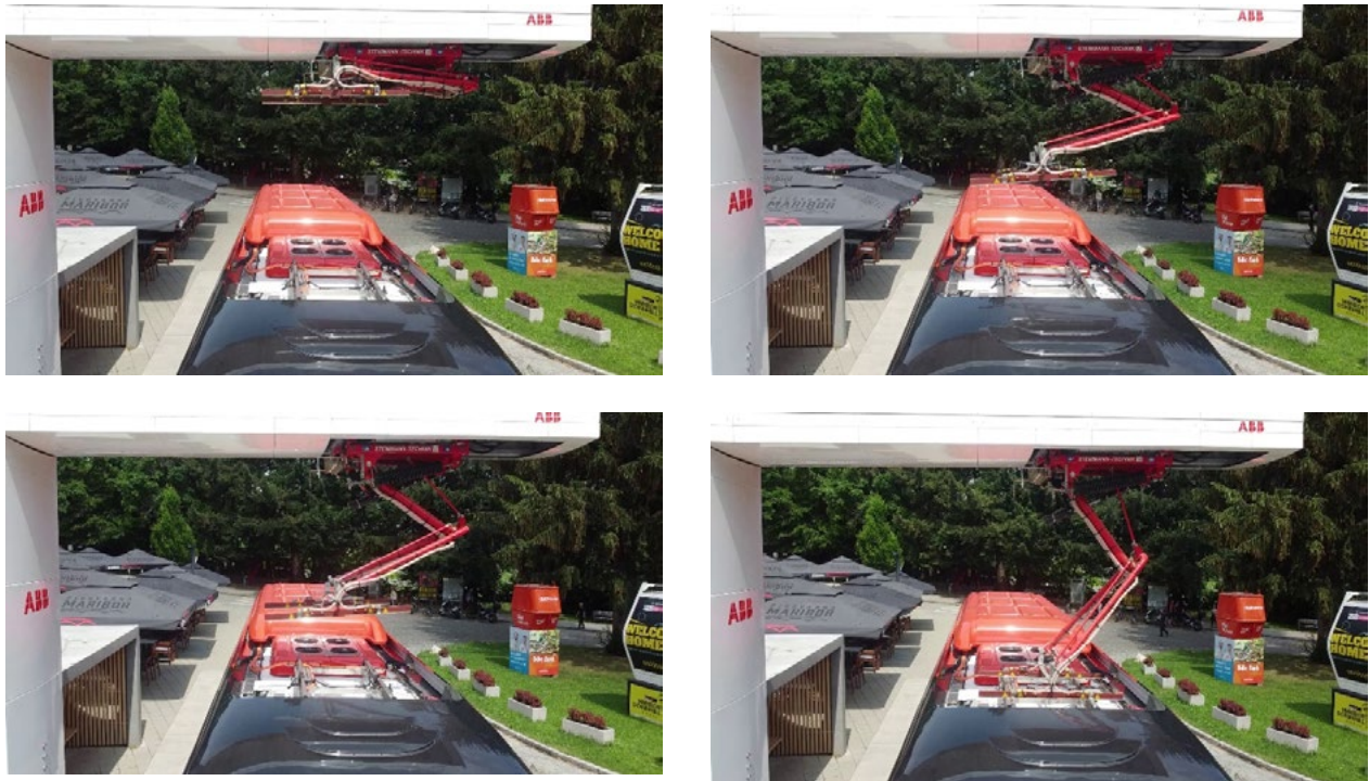
Figura 10: dimostrazione del funzionamento del pantografo (Fonte: città di Maribor)
