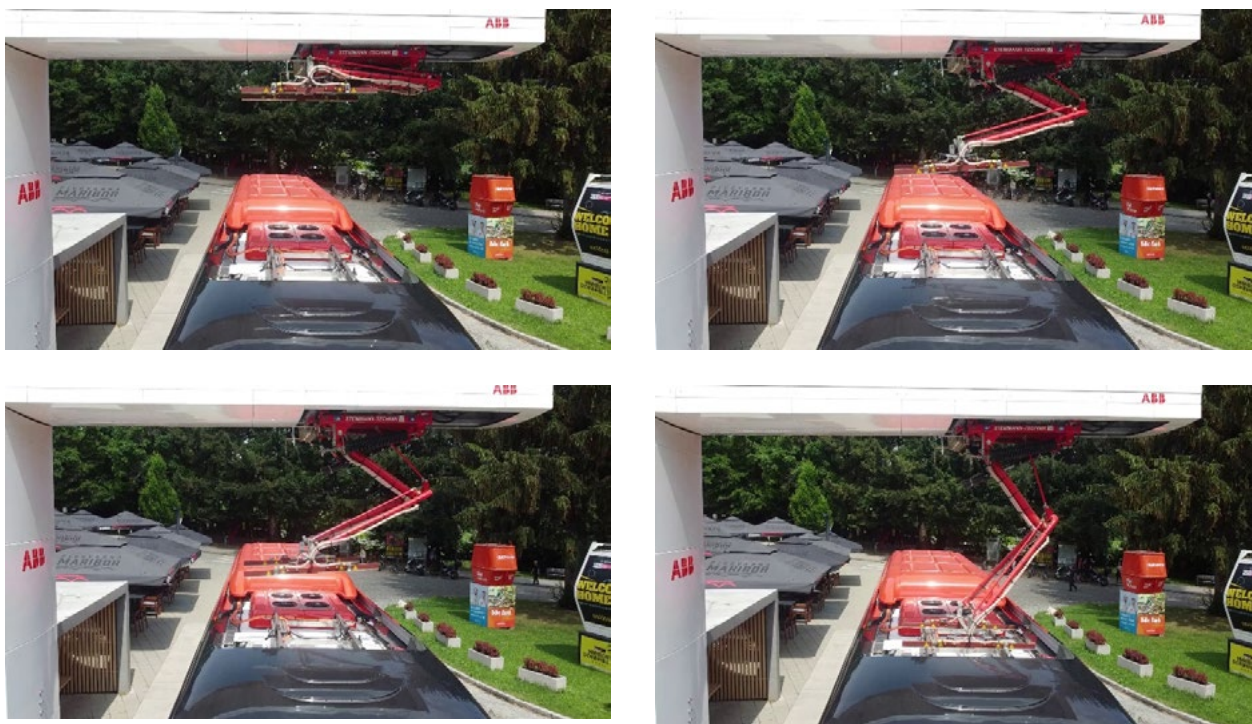
Rysunek 10: Przedstawienie działania pantografu (Źródło: Miasto Maribor)
