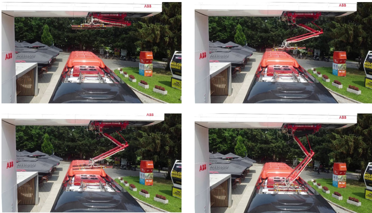
Slika 10: Demonstracija rada pantografa (Izvor: Grad Maribor)
