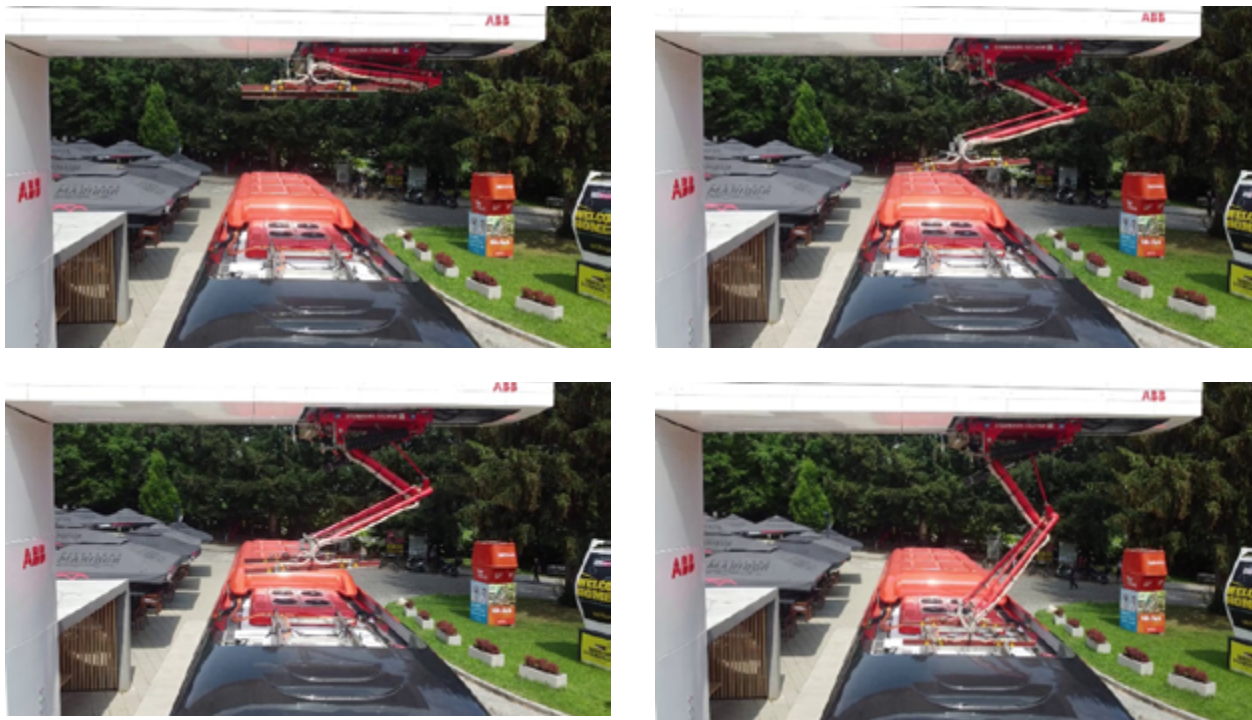
Obrázek 10: Ukázka provozu pantografu [Zdroj: Město Maribor]
