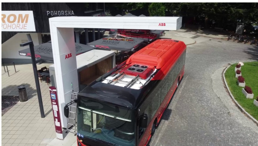
21. ábra: A beszerelt áramszedő tesztelése a megvásárolt busszal
