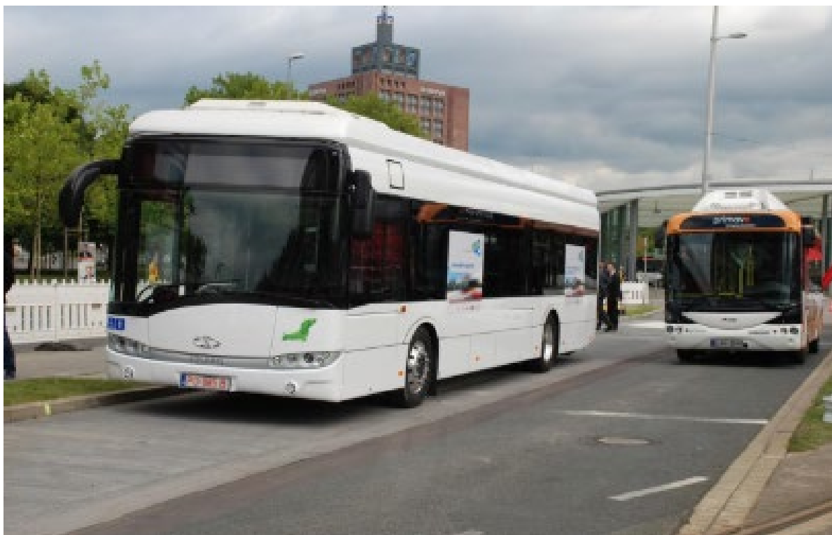
Slika 15: Električni avtobus z induktivnim polnjenjem v Braunschweigu. Vir: Rupprecht Consult.
