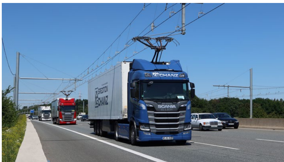
Slika 16: Testna proga za e-avtoceste ELISA 2020. Vir: M. Werner (TU Dresden)
