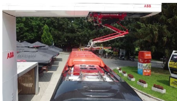
Slika 21: Preizkus nameščenega odjemnika toka s kupljenim avtobusom
