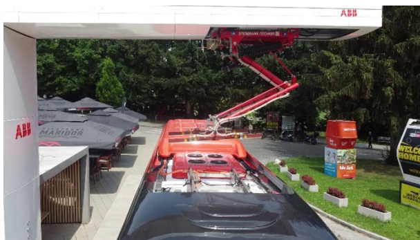
22. ábra: Az áramszedő működésének bemutatása
