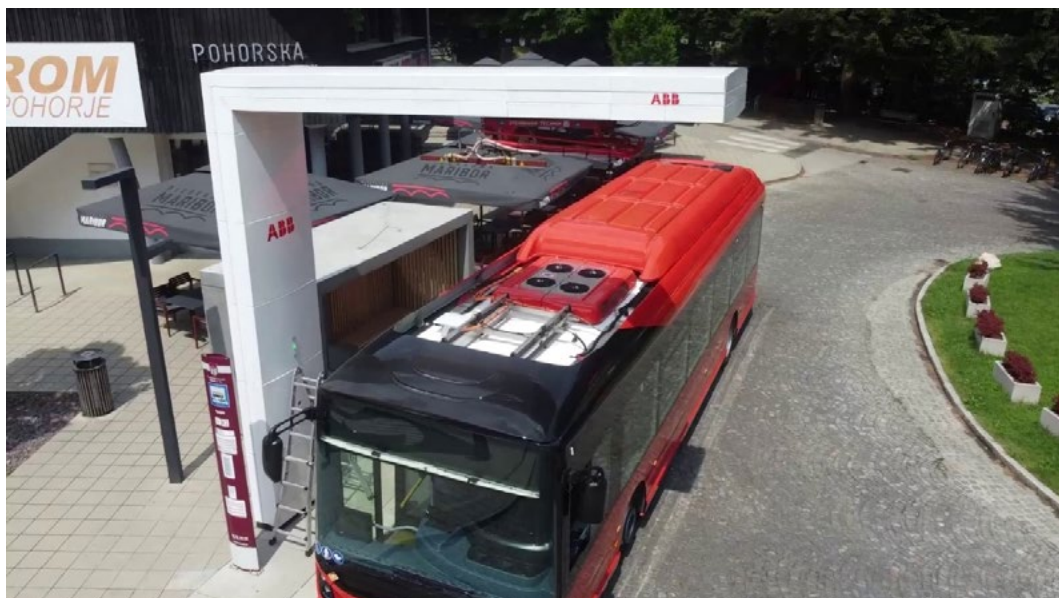
Slika 21: Preizkus nameščenega odjemnika toka s kupljenim avtobusom
