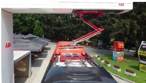
Slika 22: Prikaz delovanja odjemnika toka
