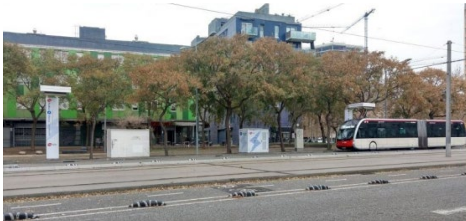
Slika 11: Polnjenje odjemnika toka v Barceloni kot del ambicioznega načrta za elektrifikacijo. Vir: TMB.
