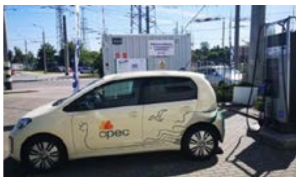
Figura 6: stazione di ricarica mobile per auto elettriche alimentata dalla rete filoviaria (PKT)
