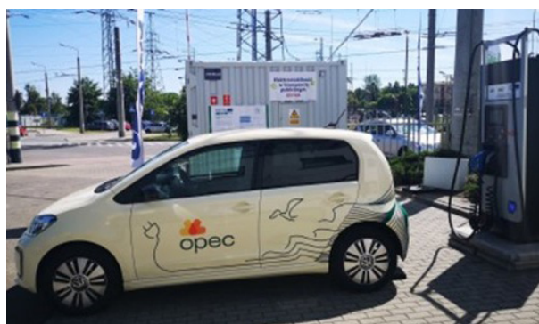
6. ábra: Mobil töltőállomás a trolibuszhálózatról (PKT) táplált elektromos autók számára
