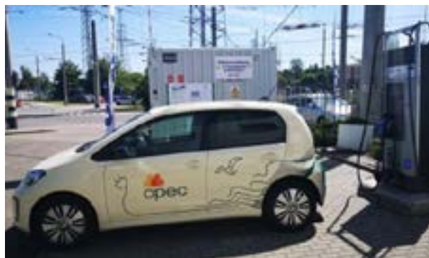
Rysunek 6: Mobilna stacja ładowania samochodów elektrycznych zasilana z sieci trolejbusowej (PKT)
