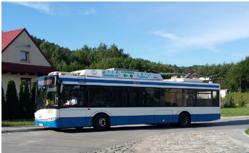
Figura 5: un filobus di PKT Gdynia in modalità operativa di ricarica in movimento a Gdynia (Foto di Marcin Wolek)
