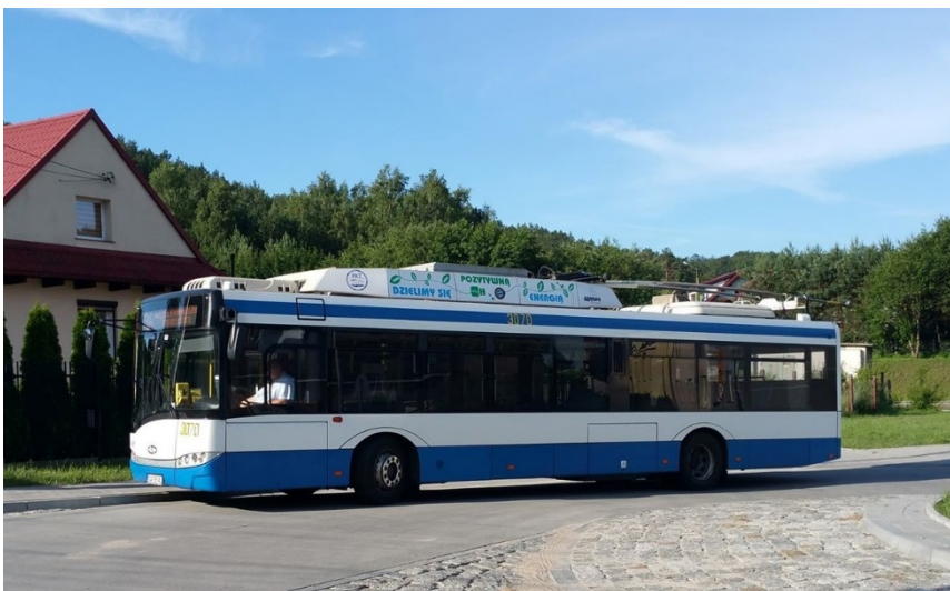
5. ábra: A PKT Gdynia egyik trolibusza menet közbeni töltés üzemmódban Gdyniában (Fotó: Marcin Wolek)
