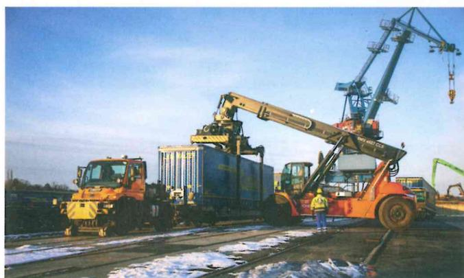
TrailerPort Alberhafen - Sattelaufzieger wird direkt auf Bahn verladen | Bild: SMWA
